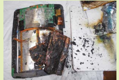
▲発火したタブレット端末 リチウムイオン電池は、衝撃を受けると発火・爆発する可能性があります
