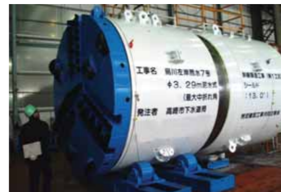
このような機械で下水管きよを築造します。
