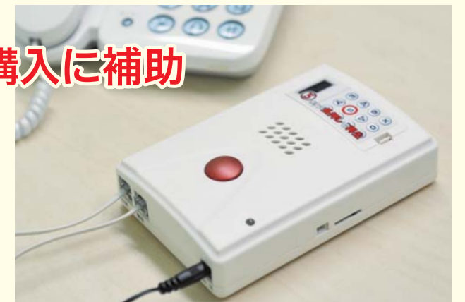
特殊詐欺対策電話装置。電話がかかってくると「この電話は犯罪被害防止のため、会話内容が自動的に録音されます」などとメッセージが流れ、相手との通話の内容が録音される
