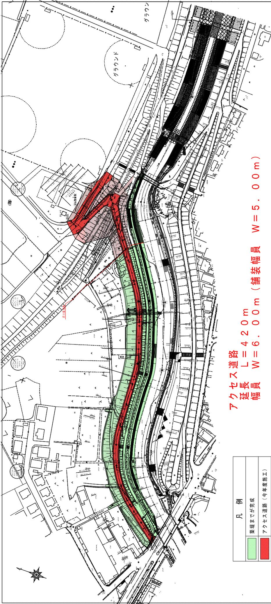
アクセス道路 延長 幅員 W = 6.00m (舗装幅員 W = 5.00m)
