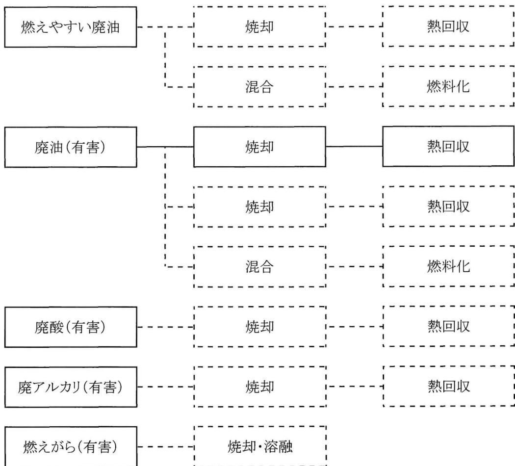
※実線は社内の処理の工程、点線は社外委託の処理の工程
