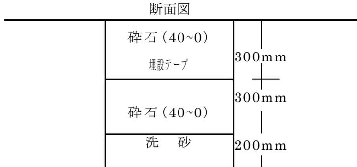
※ 平成12年3月以前に布設された管からの取り出しについては、今までどおり管上1.2mとする。ただし道路縦断に布設する場合は、配水支管より乙止水栓までは管上1.2mとし、乙止水栓二次側は管上0.8mの埋設深とする。
