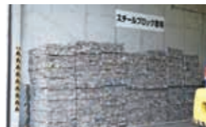
圧縮加工された鉄くず
