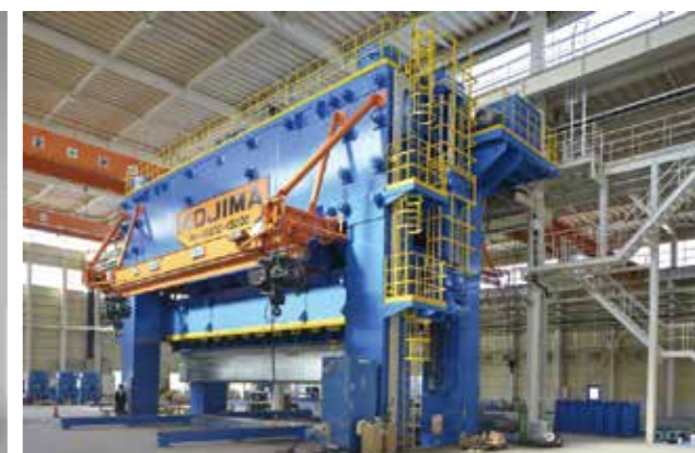
機械・油圧プレス機の専門メーカー。写真は世界最大級を誇る製品で、厚さ最大100mm、長さ最大13.5mの鋼板で巨大な部品を作ることができる
